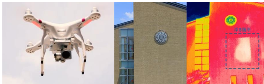
外壁・インフラ点検特化のドローン 赤外線で漏水箇所等を発見
